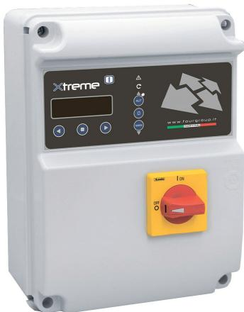
XTREME – пульт управления для прямого запуска 1 одно- или трехфазного насоса с защитой от сухого хода, по cos-ф и по минимальному току, с дистанционным управлением, через gsm и программное приложение. Устройство должно быть установлено в закрытом, хорошо проветриваемом, безопасном помещении. Работает при температуре не выше +40 °C и не ниже -5 °C (относительная влажность 50% при 40 °C неконденс.).
